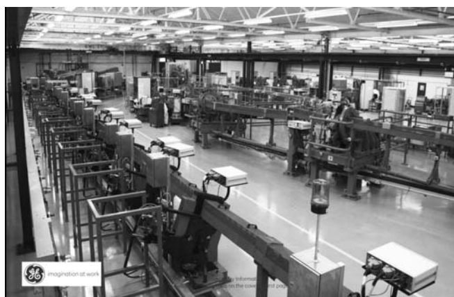
图2 B787飞机襟缝翼作动系统试验台 Fig.2 Boeing 787 LE & TE systems test rig
