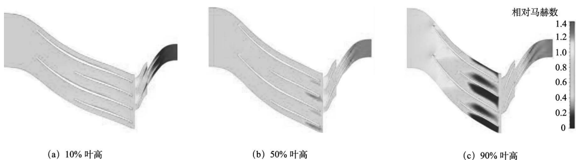
图 11 串列叶栅扩压器相对马赫数图 Fig.11 Relative Mach number of tandem cascade diffuser
