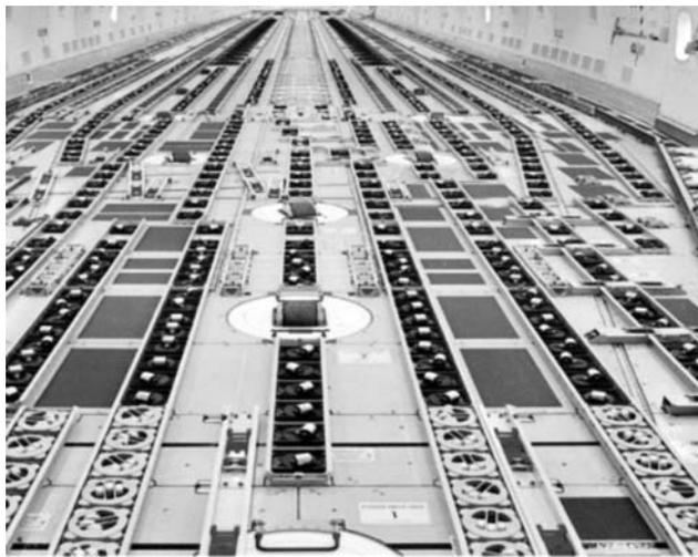
图2 先进货物装载系统(波音747)
