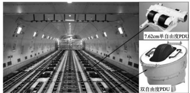
图4 大中型货机主舱货物装载系统
