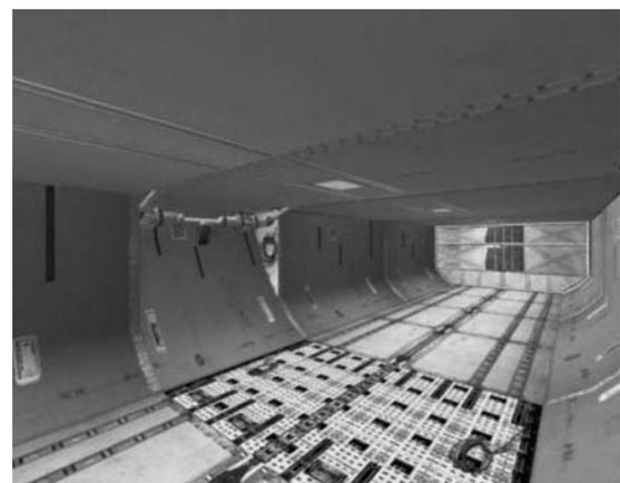
图5 宽体飞机腹舱货物装载系统
