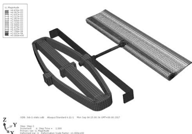
图5 襟翼驱动机构的位移云图
