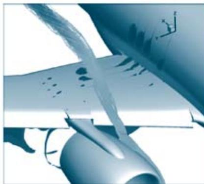
图4 流动控制技术在C919飞机设计中的应用
