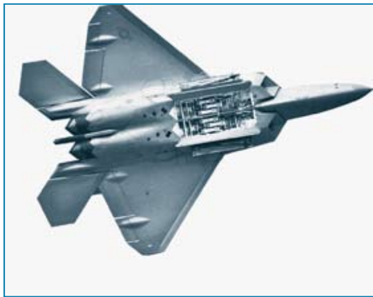
图4 F-22的内埋侧武器舱和主武器舱
