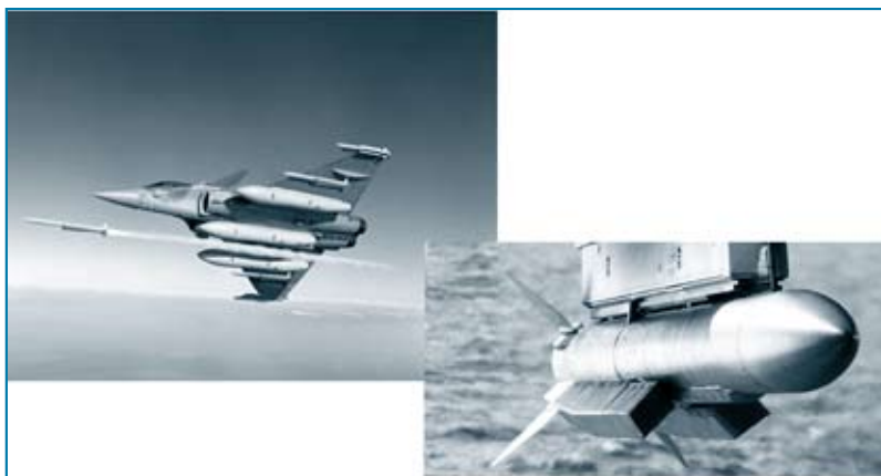
图5 采用固冲发动机的流星(Meteor)空空导弹
