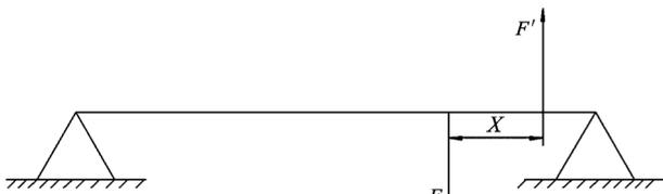
图 2 低压涡轮转子平衡简化模型
