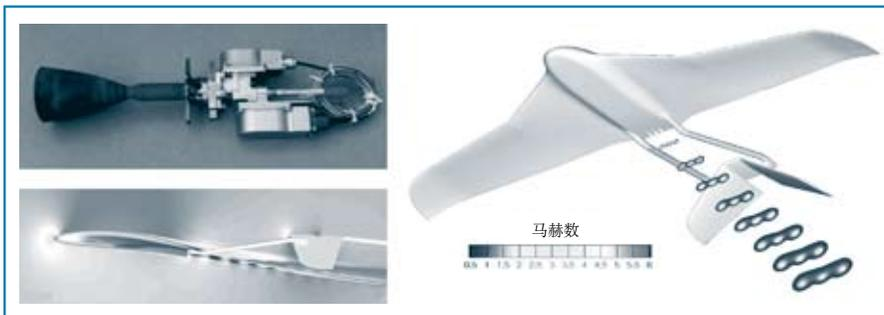
图5 AMPAC-ISP 22N推进器和CFD模拟研究
