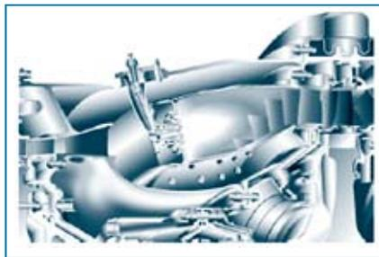
图3 TALON II 燃烧室燃焰示意图
