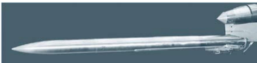
图7 VFDR-FVC 进气道风洞模型
