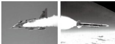
图4 “流星”导弹的飞行试验,发射和助推阶段早期
