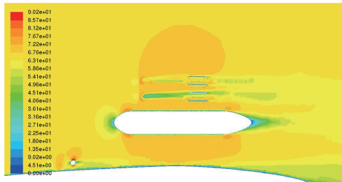
图14 无旋翼状态下副油箱水平剖面速度分布云图
