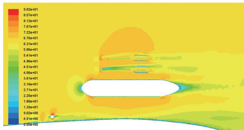
图15 有旋翼状态下副油箱水平剖面速度分布云图
