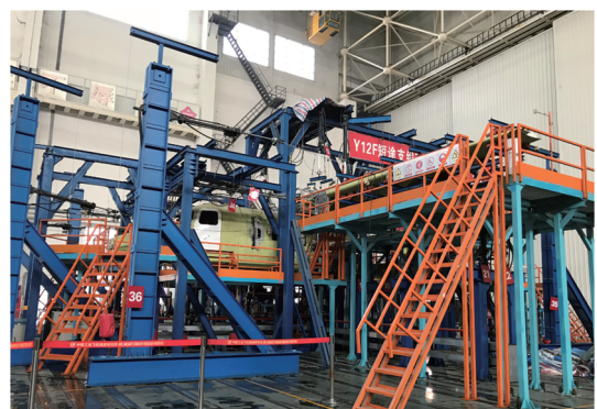
图1 某通用飞机全尺寸疲劳试验
