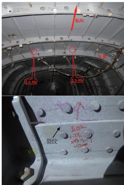
图2 LS-98框缘裂纹
