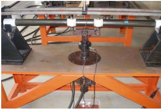
图7 尾减管变形加载试验台
