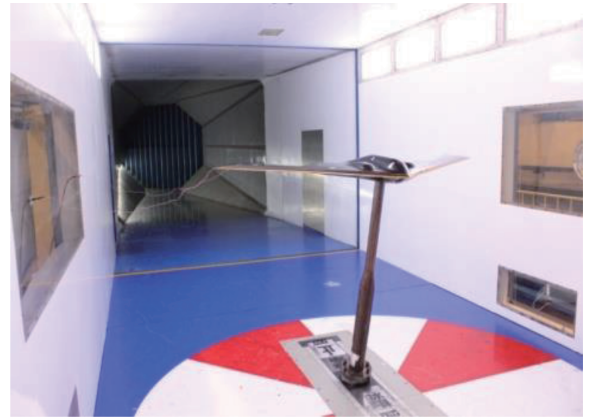
图3 等离子体静态测力试验
