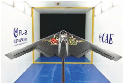
图1 虚拟飞行试验模型以及内部设备
