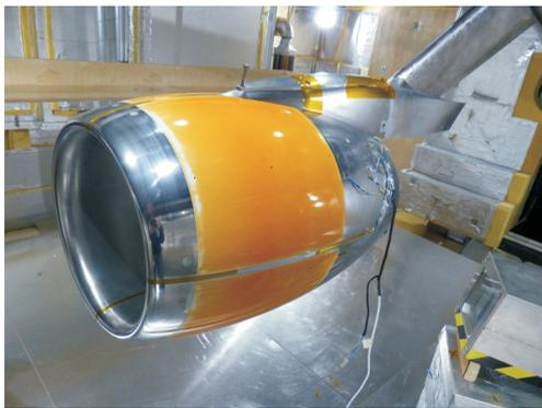
图 9 短舱上 TSP 喷涂区域显示(黄色)
