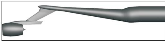
图 8 单独自然层流短舱风洞试验构型
