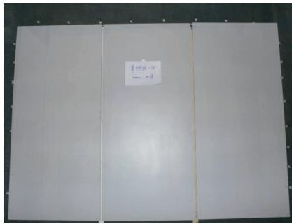
图8 无缝拼接内饰板安装于飞机壁板
