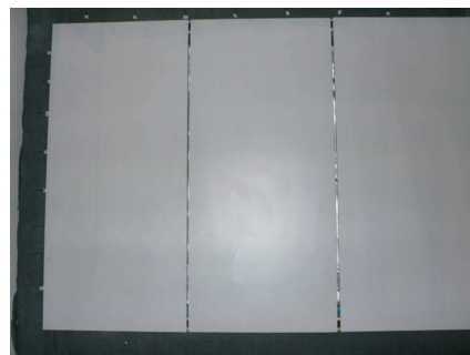
图7 有缝拼接内饰板安装于飞机壁板
