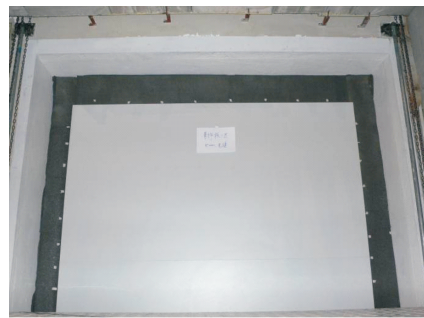
图6 完整内饰板安装于飞机壁板
