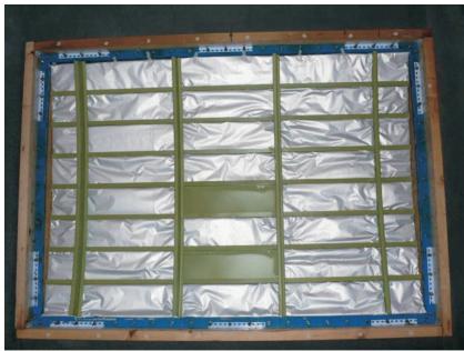
图3 隔声隔热层安装方式1
