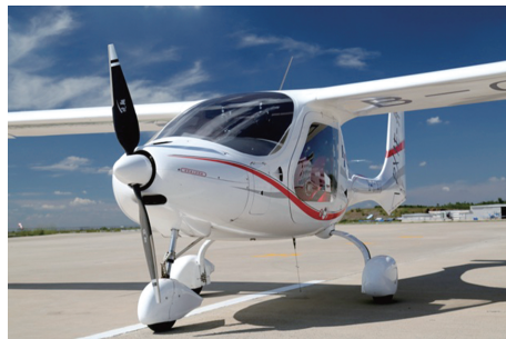
图2 RX1E-A 增程型电动飞机
