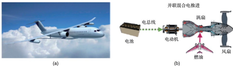
图5 波音亚声速超绿色飞机研究(SUGAR)提出的SUGAR Volt 方案 Fig.5 Boeing Subsonic Ultra Green Aircraft Research (SUGAR) Volt
