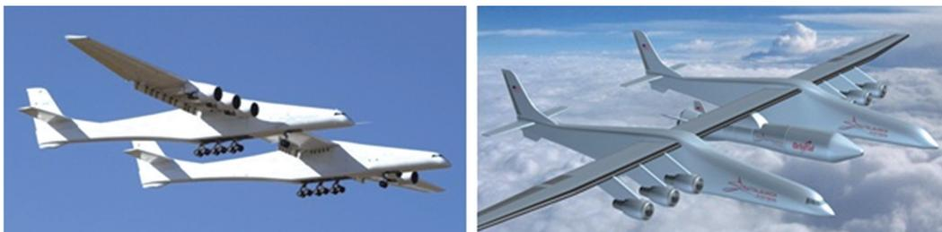
“巨鸟”采用对称双机身和平直上单翼,充分利用平直翼升力大、低速飞行性能好的特点。每侧机身都装有平尾和垂尾,平尾也为平直翼,嵌入到垂尾中。每个机身外侧翼吊三台发动机。每个机身下部都装有主起落架和前起落架,主起落架由三个纵列分布的四轮小车式起落架组成,前起落架为双轮。驾驶舱位于左机身,首飞中右机身舱室没有人员,空中发射时可用作空中控制舱室。该机设计上借鉴了很多波音747的系统和技術,如发动机、航电、驾驶舱、起落架等。同温层发射系统公司还购买了两架波音747-400飞机,将它们解体拆用。“巨鸟”的另一大特点是采用大量复合材料和增材制造技术制造的结构部件,最大部件长度达62m。大量复合材料大幅降低了重量,提高了机体强度,增强了承载能力,特别是保证中央翼盒的强度能够满足挂载大型火箭的要求。
