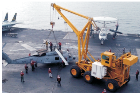
图14 救援吊车正在吊运直升机
