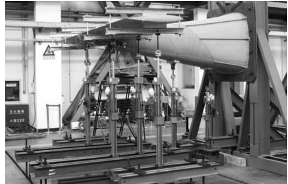
图 3 尾翼疲劳试验安装图
