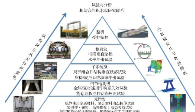
图8 民机适坠性多层级研究技术体系
