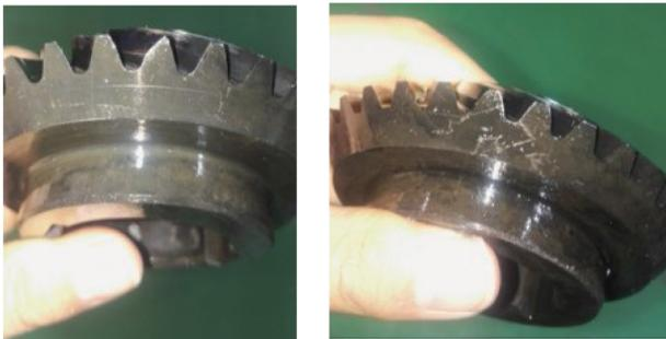
(a) 1/4 断齿故障 (b) 1/2 断齿故障
