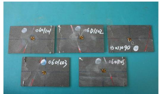
图9 试验件破坏图片
