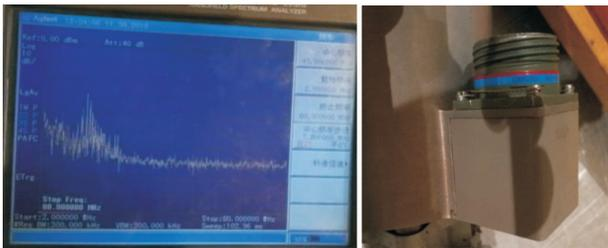
图11 电动机泄漏点(插座接缝处)
