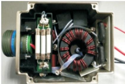
图20 滤波器内部结构
