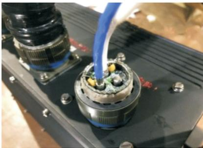
图26 增加电源线上的共模电容
