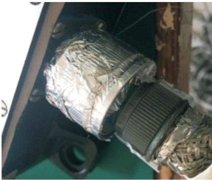
图25 插头尾附与屏蔽套采用360°连接
