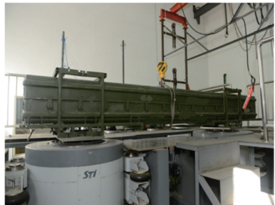
图5 振动台模拟运输安装图
