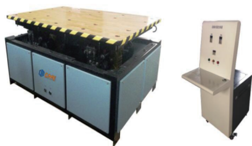
图1 运输模拟台示意图 Fig.1 Diagram of transport simulator
