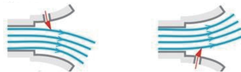
(b) FTV喷嘴控制原理
