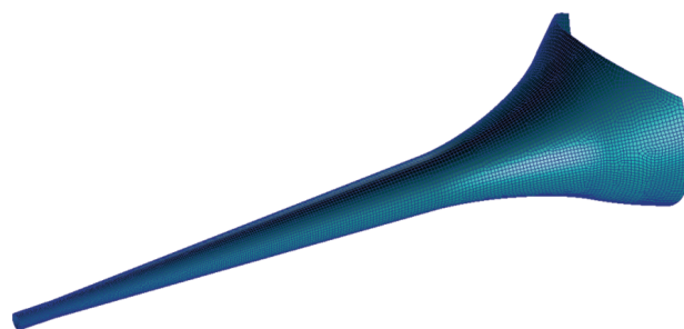
图7 复合材料前支杆网格模型
