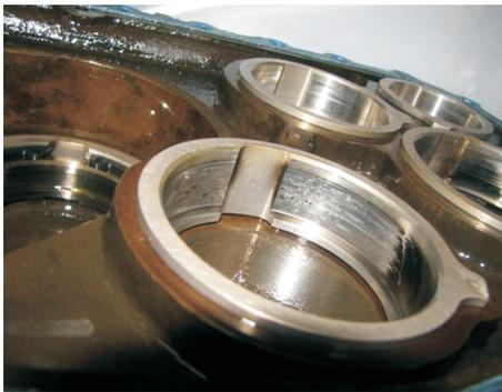
图2 衬套磨损示意图
