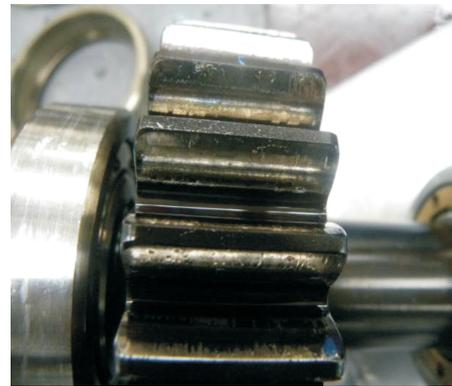
图3 齿轮磨损示意图
