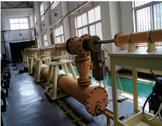
图3 高速气炮系统 Fig.3 High-speed gas gun system
