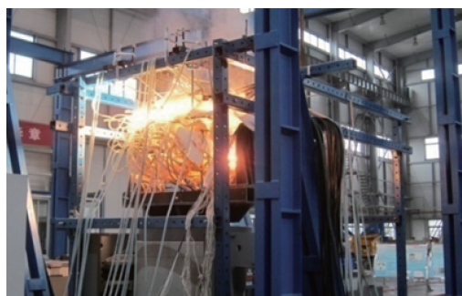
图11 富氧环境热结构热/振动耦合试验
