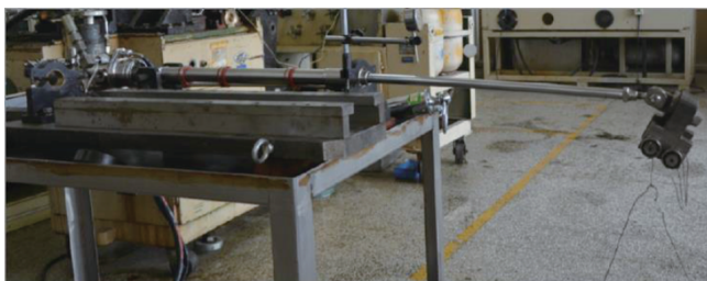
图8 反推作动器侧向载荷试验
