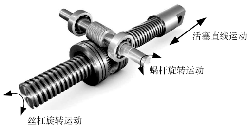
图4 反推作动器机械运动原理图
