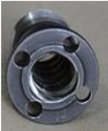
图6 表面存在损伤的丝母实物图
