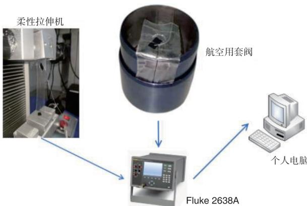
图2 传感器试验装置示意图
