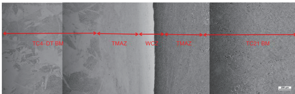
图3 光学显微镜下的接头组织 Fig.3 OM micrographs of joint cross-section
