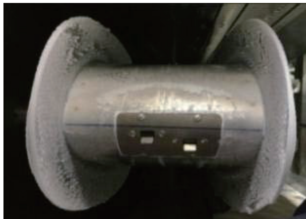
图5 间断最大结冰条件下的除冰试验结果
