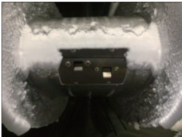
图4 连续最大结冰条件下的防冰试验结果
