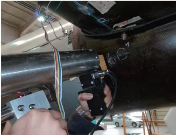
图4 尾段结构冲击缺陷的制作
