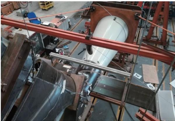
图5 尾段结构损伤容限试验现场
