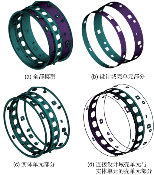
图2 实体单元与壳单元混合模型
