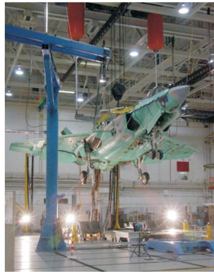
图6 F-35C全机落震试验图
