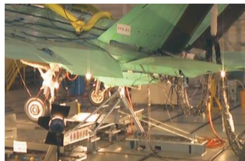
图7 全机落震试验压溃装置图
