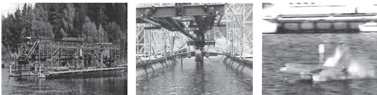
图5 湖泊水上漂浮弹射装置
