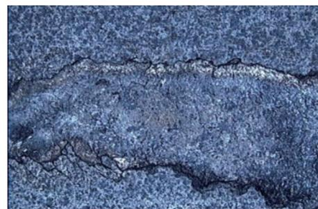
图6 超声速火焰喷涂碳化钨涂层表面形貌图
