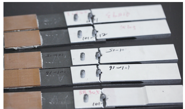
图3 疲劳试验破坏模式
