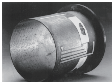
图13 测试后的圆柱形RMI-CMC构件 [17]
