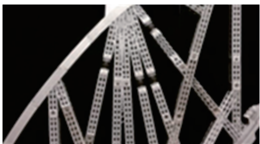
图3 空客3D打印机舱隔离结构及试验件
