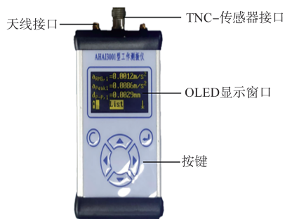
图7 AHAI3001型工作测振仪
