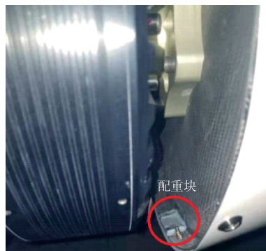
图6 四座电动飞机配重位置
