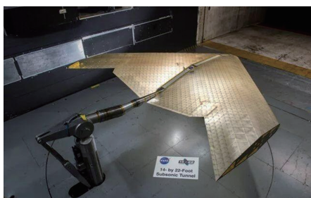
图58 基于点阵结构设计的变体机翼
