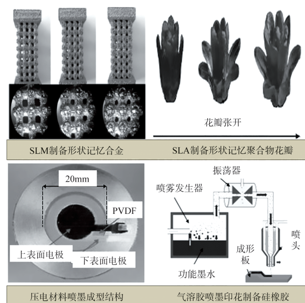
图56 智能材料通过4D打印制备
