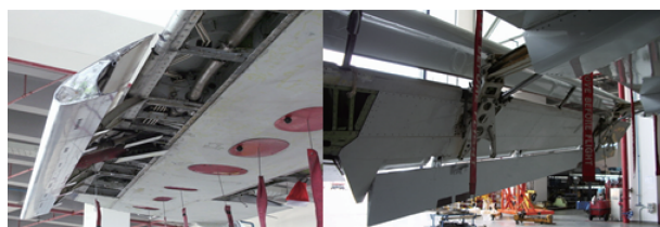
(a) 传统前缘缝翼和后缘多段缝翼
