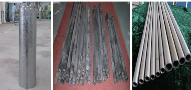
图11 记忆合金 Ni_{47}Ti_{44}Nb_9 铸锭、棒材、管材
