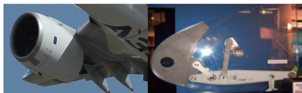
(b) A380/A350XWB采用的变弯度下垂前缘
