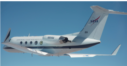
图16 自适应后缘应用于湾流III亚声速飞机上
