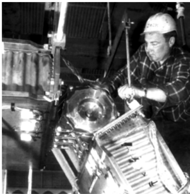
图3 XB-70可折叠翼尖驱动铰链和结构细节 [11]
