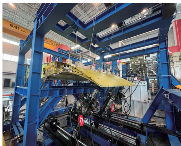
图11 后缘加载试验
