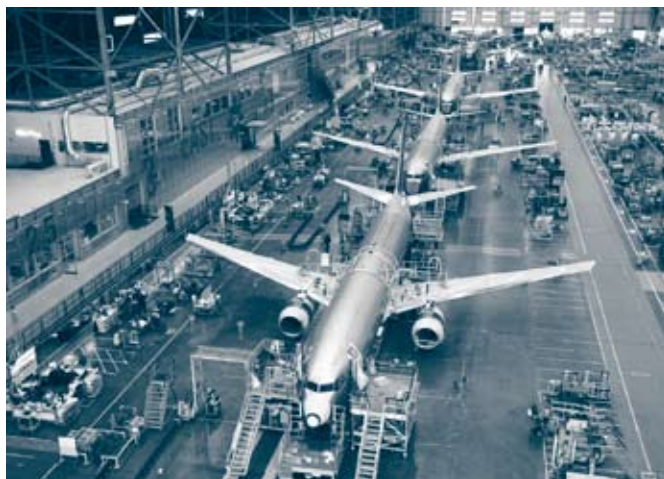
图2 波音737移动生产线
