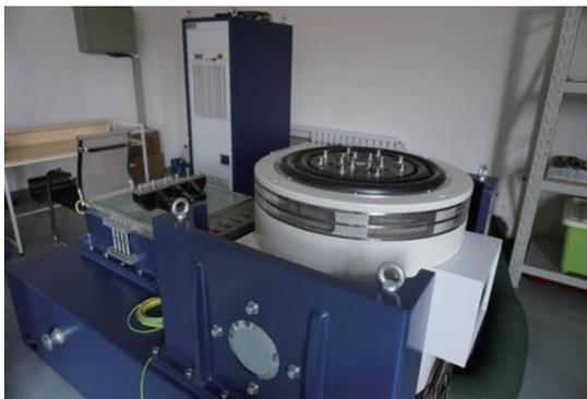
图1 高频电动振动试验系统
