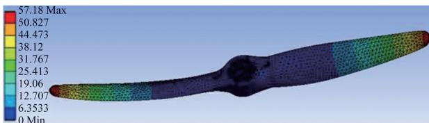
图10 W80CM8型螺旋桨一阶模态
