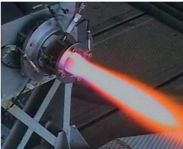
图6 MBDA小尺寸旋转爆震发动机演示试验
